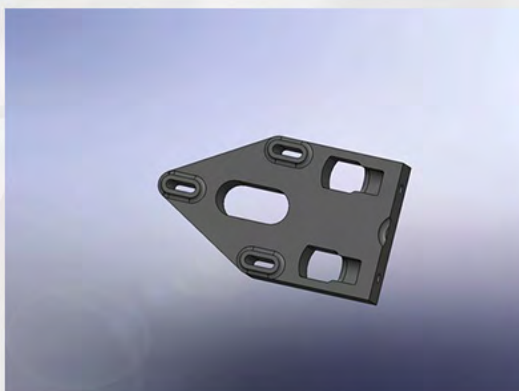
Βάση κινητήρα: το σχέδιο που χρησιμοποιήθηκε στην τρισδιάστατη εκτύπωση με PETG ή PETG-carbon
