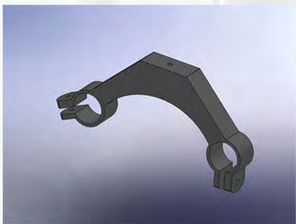
Σχέδιο τμήματος της πρωτότυπης βάσης στήριξης της φιάλης υδρογόνου
