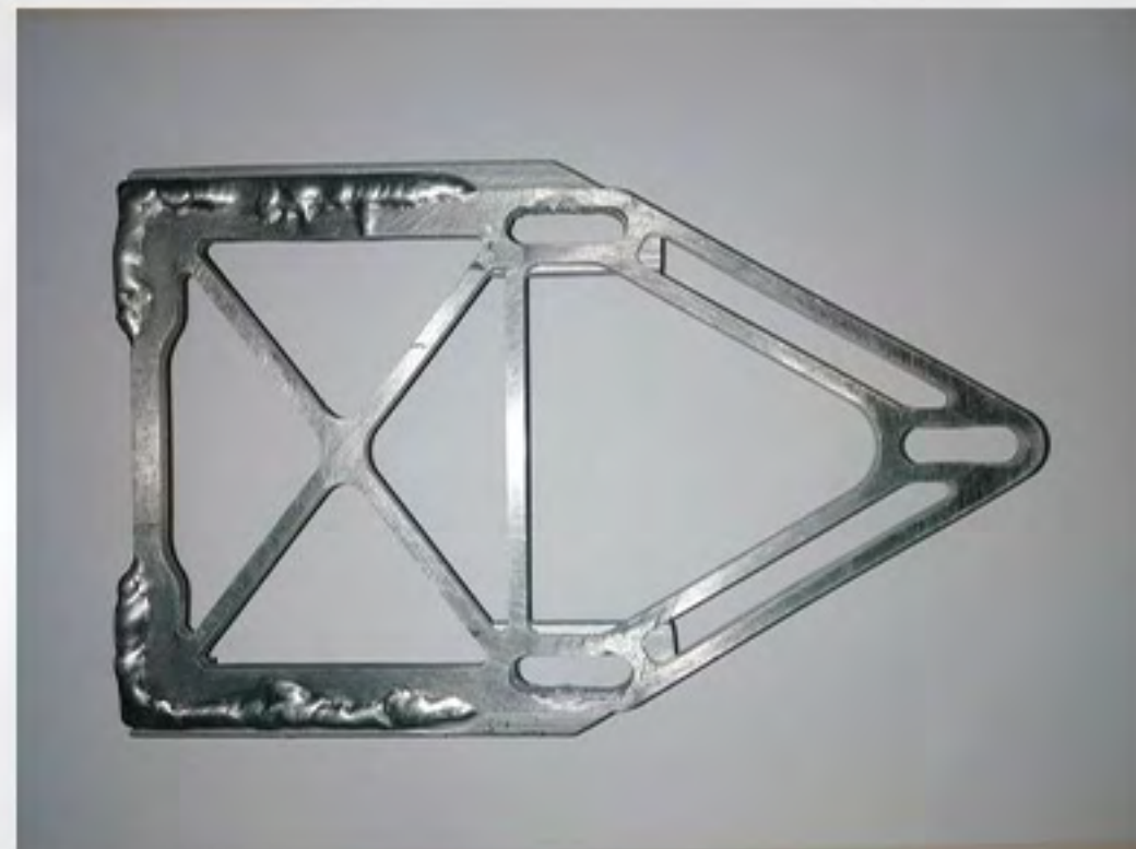
Βάση κινητήρα: το πρώτο μεταλλικό πρωτότυπο
