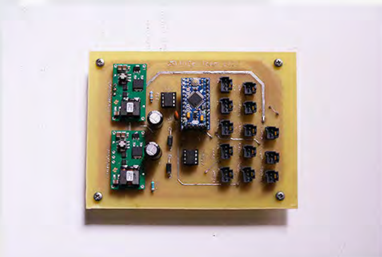
Πρωτότυπη ηλεκτρονική πλακέτα των φωτιστικών σωμάτων του νέου οχήματος
